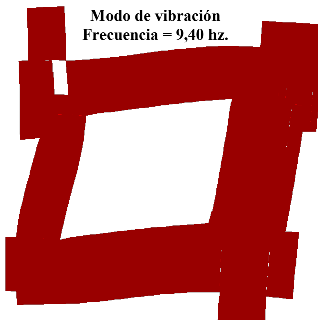
Figura 5.2. 155.- Modo de vibración U.E.N. Experimental Venezuela (Arreglo 1).
