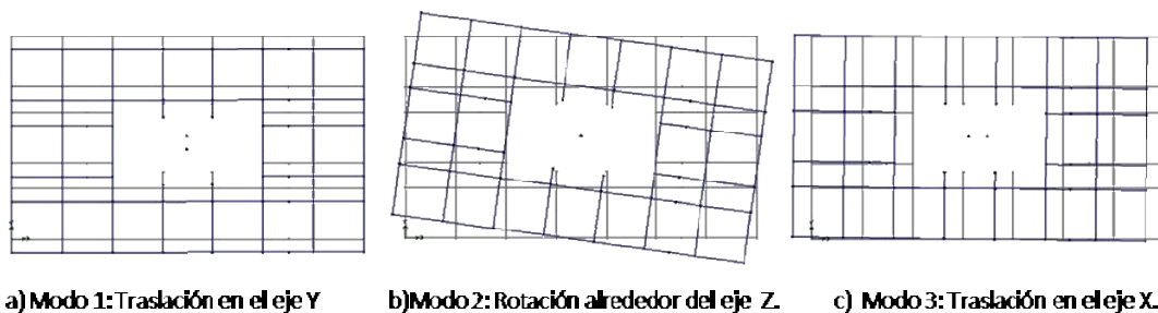
Figura 4.7.14.- Formas modales obtenidas para los Modelos 1 y 2 de la U. E. Escuela Básica Corazón de Jesús.
