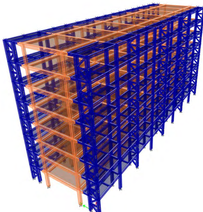
Imagen 3D del edificio reforzado. En color naranja la estructura existente y en azul, la estructura de acero suplementaria de refuerzo.
